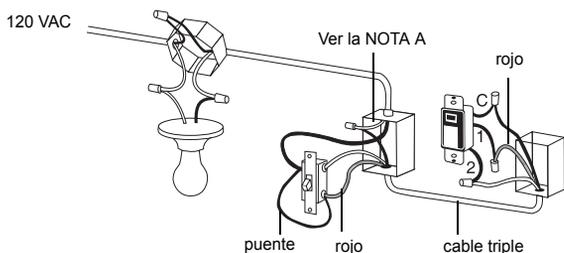
Conectar el cable "C" del RPLS530A/RPLS531A al cable "común" identificado cuando se retiró el antiguo interruptor. Conectar los otros dos cables del RPLS530A/RPLS531A a los dos cables restantes.
