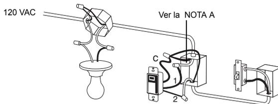
No es necesario un cable de puente en esta instalación. En el caso de una instalación de 3 vías, el otro interruptor puede ser un interruptor unipolar.
