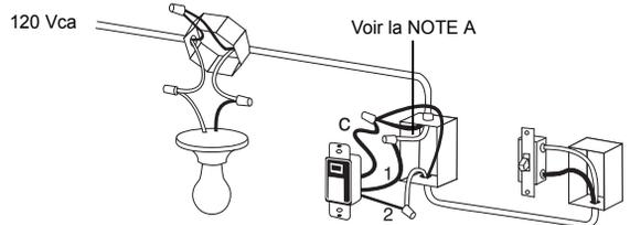
Le fil de raccord n'est pas requis dans cette installation. Dans le cas d'une installation à 3 voies, l'autre interrupteur peut être un interrupteur unipolaire.
