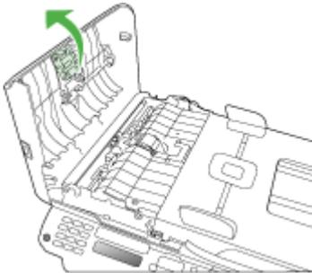
4. Heben Sie den Mechanismus des automatischen Vorlageneinzugs an.
