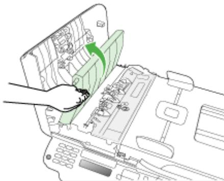
5. Reinigen Sie den Kunststoffstreifen mit einem mit mildem Glasreiniger befeuchteten weichen Tuch oder Schwamm.
