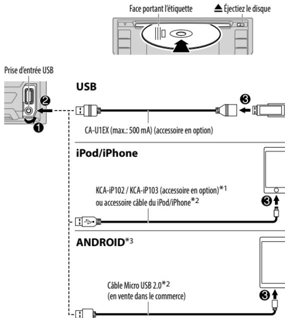
\*1 KCA-iP102 : Type à 30 broches, KCA-iP103 : Type d'éclairage
