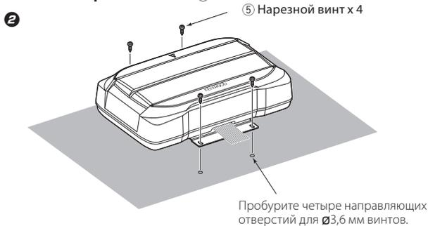
Пробурите направляющие отверстия для  $\varnothing 3,6$  мм винтов на участке листового металла автомобиля, и с помощью шурупов прикрепите колонку к автомобилю (5).
