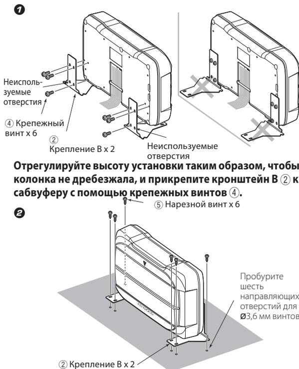
Отрегулируйте высоту установки таким образом, чтобы колонка не дребезжала, и прикрепите кронштейн В (2) к сабвуферу с помощью крепежных винтов (4).
