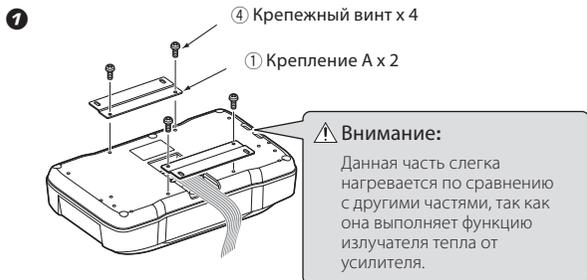
Надежно прикрепите крепления А (1) к колонке с помощью крепежных винтов (4). Соблюдайте предосторожность, и не давайте подключенным кабелям оставаться между колонкой и креплениями А (1).
