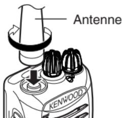
Vissez l'antenne sur le connecteur au sommet de l'émetteur-récepteur en tenant l'antenne par la base et en la tournant dans le sens horaire jusqu'à la fixer correctement en place.
