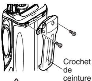
Si nécessaire, fixez le crochet de ceinture à l'aide des deux vis M3 x 8 mm fournies.
