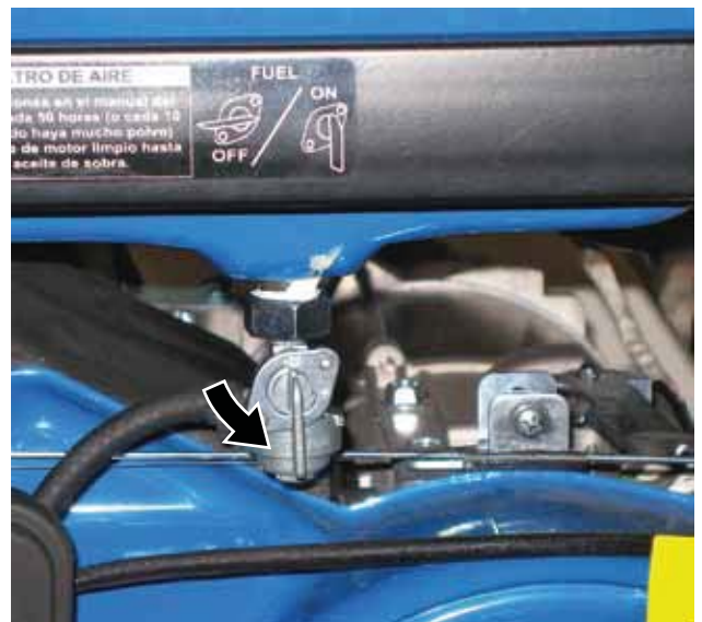
Figura 27 – Válvula de cierre del combustible en la posición ON (encendido)
