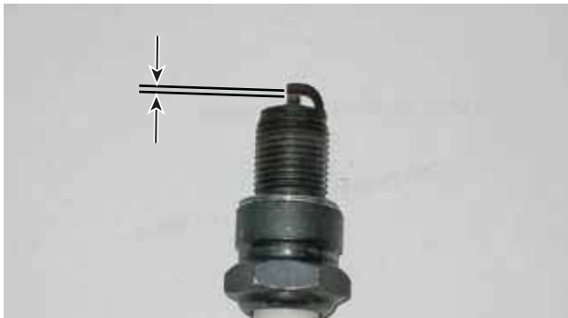
Figura 41 – Requisitos de separación de la bujía
