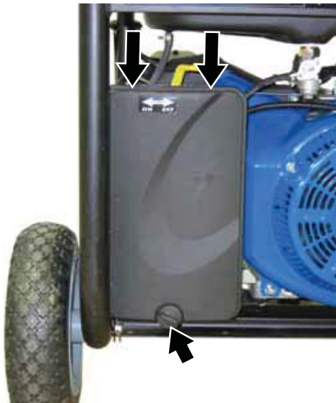
Figura 38 – Colocación de la cubierta del filtro de aire
