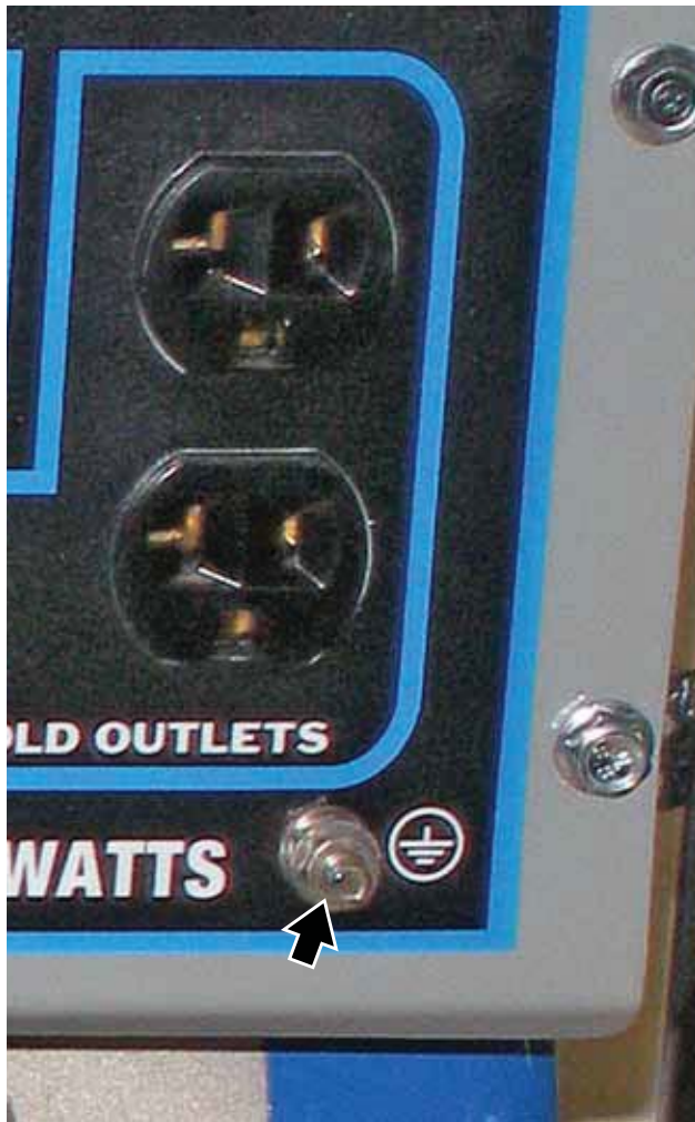
Figura 19 – Terminal de conexión a tierra del panel de control
