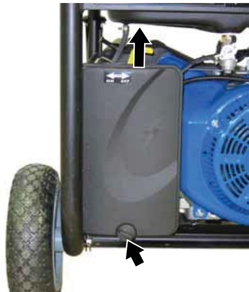
Figura 35 – Procedimiento para retirar la cubierta del filtro de aire
