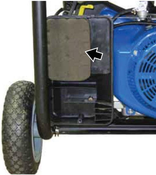
Figura 36 – Procedimiento para retirar el elemento del filtro de aire
