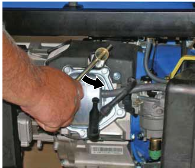
Figura 40 – Procedimiento para extraer la bujía
