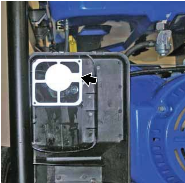
Figura 37 – Ubicación de la placa metálica de explosión al carburador
