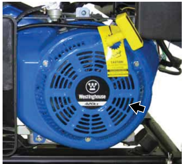
Figura 44 – Orificios de entrada y salida de aire del motor
