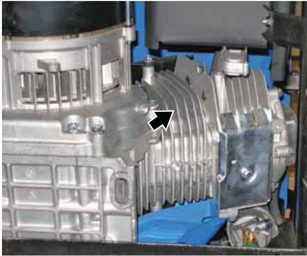
Figura 45 – Aletas de refrigeración del motor
