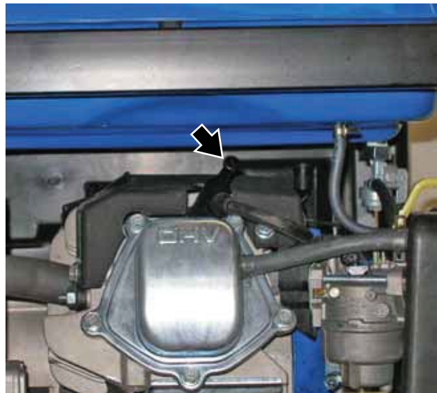
Figura 39 – Procedimiento para retirar el capuchón de la bujía de encendido
