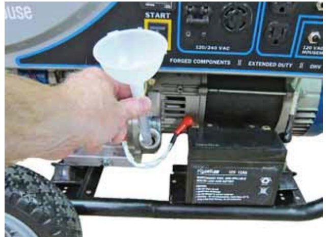
Figura 33 – Procedimiento para agregar el aceite del motor
