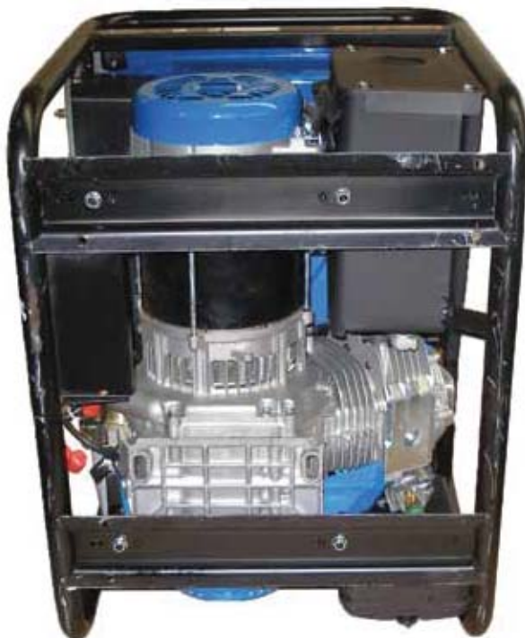
Figura 11 – Incline el generador de costado
