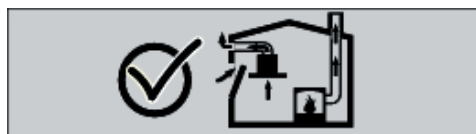
Fig. 2: Peligro de intoxicación
