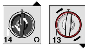
4. 朝着顺时针的转向拧转红色的链条张紧环 **13**，必须拧转到链条正确地张紧为止。机械的卡槽固定方式可以防止链条松开。如果拧转链条张紧环 **13** 时非常吃力，必须再朝着反时钟的转向拧松拧紧柄 **14**。当您调整链条张紧环 **13** 时，拧紧柄 **14** 是可以跟着转动的。
