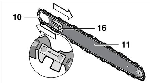
5. 把链条的传动装置安装在链条齿轮 21 上，接著再安装中插板 11。注意，固定销 17 前、后的两片插板 - 导引桥形接片 18，必须凸出于中插板 11 的长孔中。
