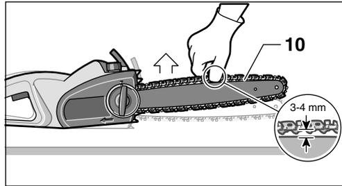
6. 如果链条 **10** 绷得太紧了，可以朝着反时钟的转向拧转链条张紧环 **13** 来放松链条。
