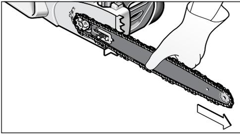
7. 正确地安装好盖子，并检查链条捕捉销 **22** 是否正确地位在盖子 **15** 上的捕捉销专用孔中。
