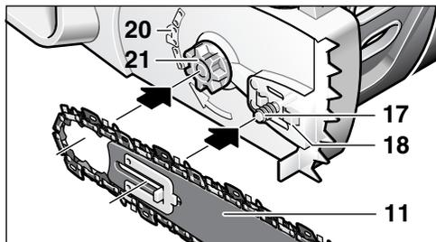
6. 检查，是否所有的零件都正确接合了，以及安装了链条的中插板是否能够固定在这个位置。
