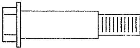
3 - Pernos con resalto de 3/8-16 x 1.390 pulgadas
