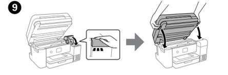
Continue to close the scanner unit even if you feel some resistance. / Продолжайте закрывать модуль сканера, даже если вы почувствуете некоторое сопротивление. / Продовжуйте закривати блок сканера, навіть якщо відчувається деякий опір. / Қандай да бір кедергіні сезсенді де сканер блогын жабуды жалғастырыңыз.
