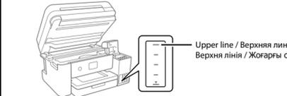
Insert the ink bottle straight into the port to fill ink to the upper line. / Вставьте бутылку с чернилами в отверстие, чтобы заправить чернила до верхней линии. / Щоб заповнити чорнила до верхньої лінії, вставте флакон із чорнилом прямо в порт. / Сияны жоғарғы сызыққа дейін толтыру үшін сия беттелкесін тікелей портқа салыңыз.
