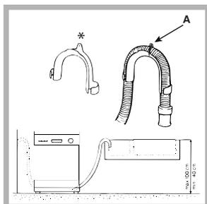
O especial cotovelo\* de matéria plástica facilita o posicionamento ideal: fixe firmemente o cotovelo ao muro para evitar que o tubo se mova e derrame a água fora da descarga. A parte da mangueira marcada com a letra A deve ficar entre 40 e 100 cm de altura (veja a figura).
