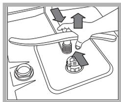
Dolny spryskiwacz demontuje się naciskając na zatrzaski umieszczone po bokach i pociągając go w górę.
