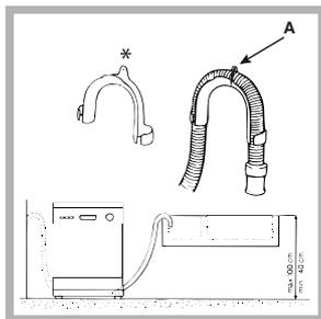
Specjalne plastikowe kolanko\* ułatwia optymalne ułożenie przewodu: dokładnie przymocować kolanko do ściany, aby uniknąć przesuwania się przewodu i wylewania wody poza odpływ kanalizacyjny. Część rury oznaczona literą A powinna znajdować się
