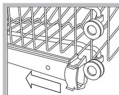
ouvrir les butées des glissières du panier à droite et à gauche et sortir le panier. Positionner le panier en position haute ou basse, le faire glisser le long des glissières jusqu'à ce que les roues avant entrent elles aussi et refermer les butées (voir figure).
