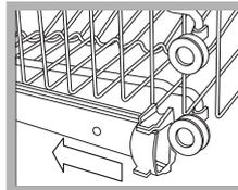
Ανοίξτε τα στοπ των οδηγών του καλαθιού δεξιά και αριστερά και βγάλτε το καλάθι. Τακτοποιήστε το ψηλά ή χαμηλά, κυλήστε το κατά μήκος των οδηγών μέχρι εισέλθουν και οι πρόσθιες ροδέλες και κλείστε τα στοπ (βλέπε εικόνα).
