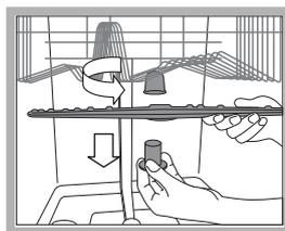
Aby zdemontować górny spryskiwacz, należy odkręcić plastikowy pierścień, obracając go w kierunku przeciwnym do ruchu wskazówek zegara. Górny zraszacz należy zamontować z otworami skierowanymi do góry.
