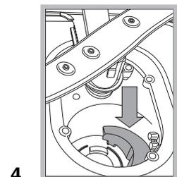
Después de la limpieza de los filtros, vuelva a montar el grupo filtrante y a colocarlo correctamente en su lugar. Esto es fundamental para el buen funcionamiento del lavavajillas.
