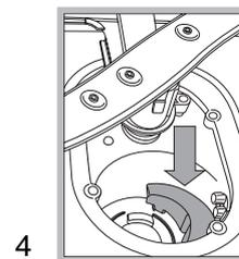
Po wyczyszczeniu filtrów należy ponownie zamontować zespół filtrujący i prawidłowo go umiejscowić; ma to zasadnicze znaczenie dla prawidłowego działania zmywarki.
