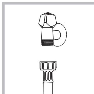
1. Podłączyć przewód zasilający poprzez przykręcenie do zaworu wody zimnej z końcówką gwintowaną  $\frac{3}{4}$  gas (patrz rysunek). Przed podłączeniem spuszczać wodę do momentu, aż stanie się ona całkowicie przezroczysta.
