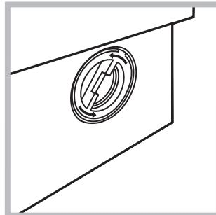
2. desenrosque a tampa girando-a no sentido anti-horário (veja a figura). é normal que perca um pouco de água;
