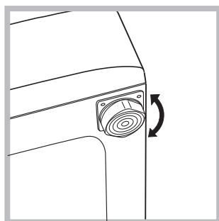
2. Si el piso no está perfectamente horizontal, compense las irregularidades desenroscando o enroscando las patas delanteras (ver *la figura*); el ángulo de inclinación medido sobre la superficie de trabajo, no debe superar los 2°. Una cuidadosa nivelación brinda estabilidad a la máquina y evita vibraciones, ruidos y desplazamientos du-
