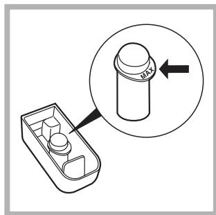
Wstawić dodatkowy pojemniczek 4, na wyposażeniu, do przegródki 1. Przy dozowaniu wybielacza nie przekroczyć poziomu „max” wskazanego na środkowej ośce (patrz rysunek). Aby wykonać tylko wybielanie, należy wlać wybielacz do dodatkowego pojemnika 4 i nastawić
