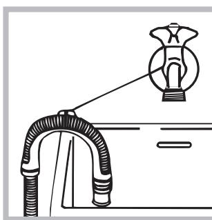
Sprinjiniți-l de marginea căzii sau chiuvetei și racordați șina de ghidare din dotare la robinet (a se vedea figura). Capătul liber al furtunului de golire nu trebuie să rămână cufundat în apă.
