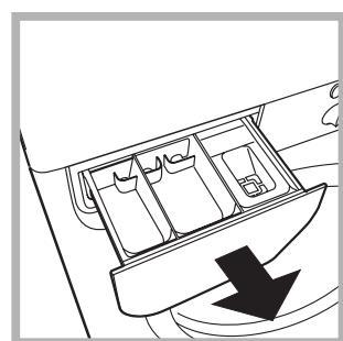
Trageți afara compatimentul ridicându-l și tragându-l spre exterior (*a se vedea figura*). Spălați-l sub un jet de apă; această operație trebuie efectuată cât mai des posibil.
