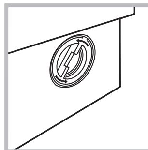
2. odšrouubujte víko jeho otáčením proti směru hodinových ručiček (viz obrázek): vytečení malého množství vody je zcela běžným jevem;
