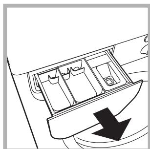
Vytáhněte dávkovač jeho nadzvednutím a vytažením směrem ven (viz obrázek). Umyjte jej pod proudem vody; tento druh vycítění je třeba provádět pravidelně.
