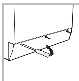
1. scoateți panoul de acoperire din partea din față a mașinii de spălat folosind o șurubelnită (*a se vedea figura*);
