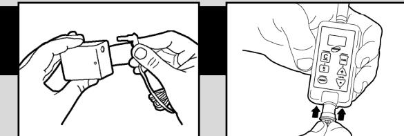
**HALSBAND:** Laad de halsband 12-14 uren op. Vergeet niet de grijze stop terug op het laadstopcontact te doen als u gedaan hebt. Steek de batterijen in de zender met de positieve pool (+) naar boven.
