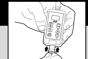
**COLLAR:** Cargue el collar de 12 a 14 horas. Una vez que haya terminado, asegúrese de cubrir el enchufe hembra de carga con el tapón gris. Coloque las baterías en el transmisor con el polo positivo (+) hacia fuera.
