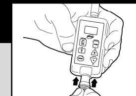
**COLLARE:** Caricare il collare per 12-14 ore. Al termine, assicurarsi di coprire la presa di carica con lo spinotto grigio. Inserire le batterie nel lato esterno positivo (+) del trasmettitore.
