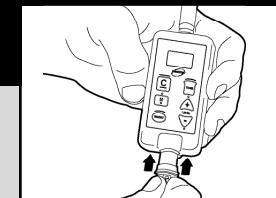
**HALSBAND:** Das Halsband 12-14 Stunden lang aufladen. Nach dem Aufladen den Ladeanschluss wieder mit dem grauen Stecker abdecken. Die Batterien im Sendegerät mit dem positivem (+) Ende nach außen einsetzen.
