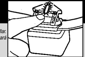
Coloque la lámpara de comprobación en los electrodos del collar. Presione el botón "C". La lámpara de comprobación se iluminará para mostrar el impulso.
