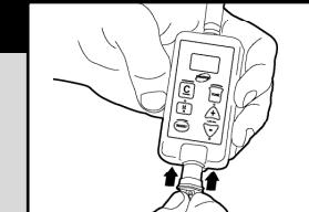
**COLLIER:** Chargez le collier durant 12 à 14 heures. Assurez-vous de bien remettre en place le couvercle gris du chargeur lorsque vous avez terminé. Insérez les batteries dans l'émetteur, borne positive (+) vers l'extérieur.
