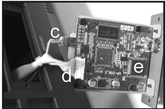
Estrarre dal relativo imballaggio la scheda video (e), facendo particolare attenzione a non toccarne i componenti con le dita. Collegarla allo strumento connettendo ad essa il rilancio di massa (c) ed il cavo di alimentazione (d), come mostrato in figura.
