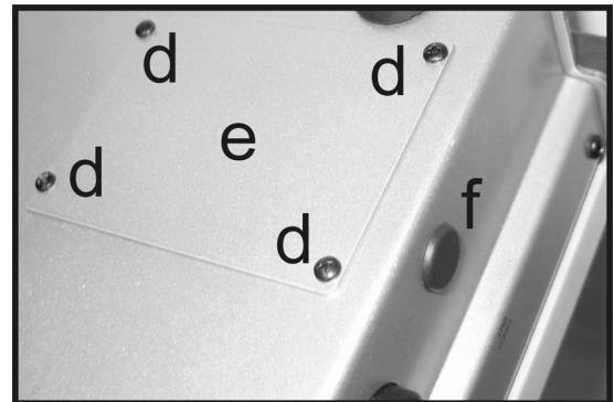
Dal fondo dello strumento, rimuovete le quattro viti di tenuta (d) e riponeteli da parte. Aprite la piastra di copertura (e) per accedere all'interno dello slot dedicato alla scheda video. Rimuovete il tassello di protezione (f) spingendolo dall'interno dello slot.
