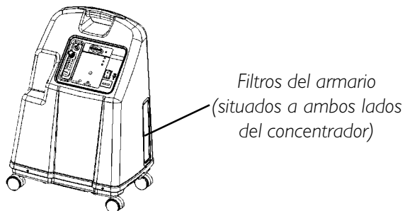
FIGURA 9 - UBICACIÓN DE LOS FILTROS EN EL ARMARIO
