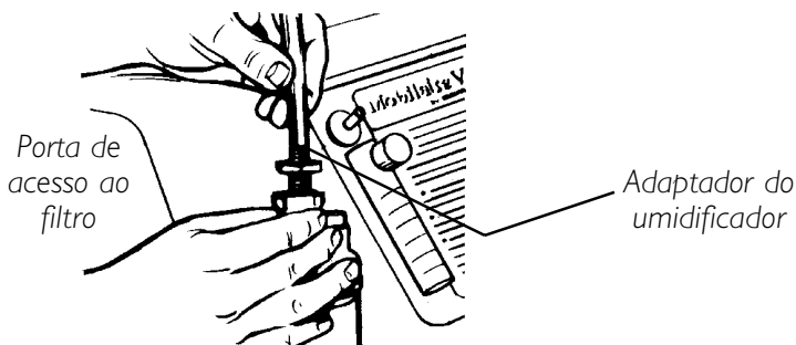
FIGURA 4 - CONECTANDO O ADAPTADOR DO UMIDIFICADOR
