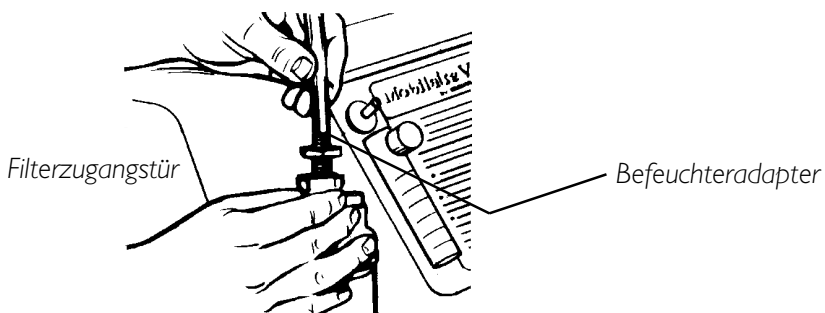
ABBILDUNG 4 - ANBRINGEN DES BEFEUCHTERADAPTERS
