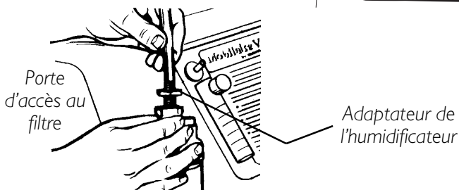
FIGURE 4 - FIXER L'ADAPTATEUR DE L'HUMIDIFICATEUR
