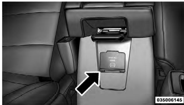
115 Volt Power Outlet
