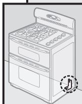
8b Drill holes as required. Mount ANTI-TIP bracket to floor with 2 concrete screws (not provided)./Percez des trous selon le besoin. Installez le support ANTIRENVERSEMENT au sol avec deux vis à béton (non fournis)./Taladre los agujeros que necesite. Instale el soporte ANTIVUELCO en el piso usando 2 tornillos para concreto (no
