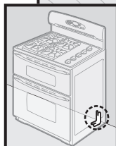
8a Drill 1/8" (3mm) holes. Mount ANTI-TIP bracket to wall or floor with 2 screws./Percez des trous de 1/8 po (3 mm). Installez le support ANTIRENVERSEMENT au mur ou au sol avec deux vis./Taladre agujeros de 1/8" (3 mm). Instale el soporte ANTIVUELCO en la pared o en el piso usando 2 visillos.
