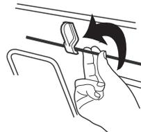
Toujours remettre l'élément de cuisson au gril en position pour la cuisson après le nettoyage.
