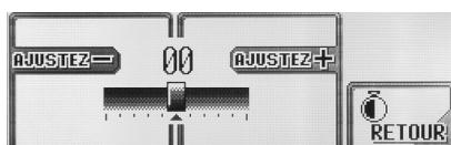
Ajustez la balance—équilibre de sortie entre les enceintes gauche et droite.
