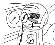
Adjust the microphone angle / Ajuste el ángulo del micrófono / Ajustez l'angle du microphone
