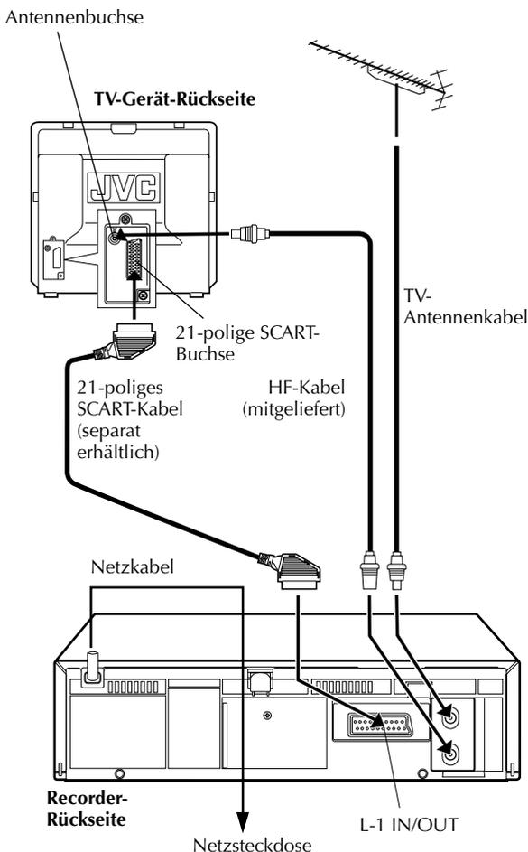
Stellen Sie den AV-Anschluss her, wenn Ihr TV-Gerät über eine 21-polige AV-Eingangsbuchse (SCART) verfügt, um Störeinstreuungen zu reduzieren. Bei Anschluss an ein Stereo-TV-Gerät ist ein separat erhältliches 21-poliges SCART-Kabel für stereophone Wiedergabe von Videocassetten erforderlich.
