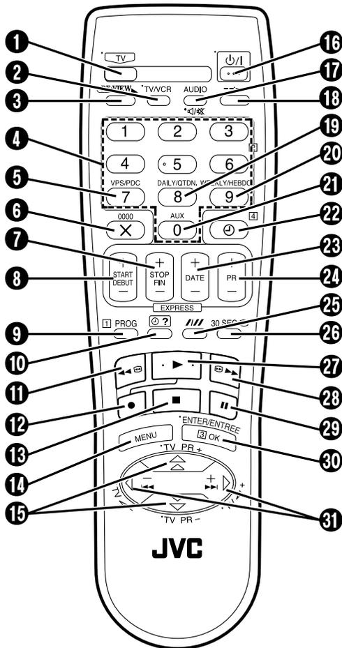
Die links neben der Beschriftung mit einem Punkt gekennzeichneten Bedienelemente können zur Fernbedienung eines TV-Gerätes der Marke JVC genutzt werden, während die Taste **TV** gedrückt gehalten wird (☞ "Fernbedienung von TV-Geräten der Marke JVC" rechts).
