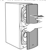
要裝上揚聲器罩網時,將揚聲器上的插銷插到揚聲器罩網上的插孔
