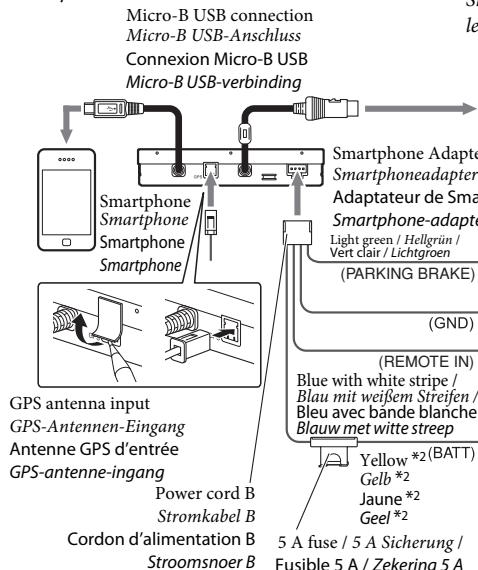
Schließen Sie die SMARTPHONE ADAPTER-Einheit an die RGB-Eingangsklemme an. Wenn Sie Ihr Smartphone über USB an die SMARTPHONE ADAPTER-Einheit anschließen, können Sie die Smartphone-Bildschirmsicht sehen.
