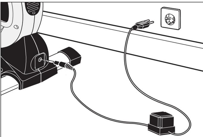
**D** Bei Geräten mit Netzteil: **Achtung!** Betrieb nur mit mitgeliefertem Original-Netzteil oder Original-KETTLER-Ersatzteil (siehe Ersatzteilliste) zulässig. **Ansonsten Gefahr der Beschädigung.**
