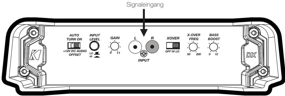
**Automatische Einschaltung:** Die DX-Serie bietet drei verschiedene automatische Einschaltmethoden, die an der Endplatte gewählt werden können: +12V, DC Offset und Audio. Wenn Sie „DC Offset“ oder „Audio“ verwenden, wird am REM-Terminal +12V für das Einschalten weiterer Verstärker bereit gestellt.
