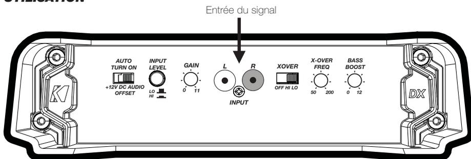
**Sélection de Mise sous Tension Automatique :** La série DX est dotée de trois modes différents de mise sous tension automatique pouvant être sélectionnés au panneau d'extrémité de l'amplificateur : +12V, DC Offset (décalage c.c.) et Audio. L'utilisation du mode DC Offset ou Audio permet à la borne REM d'avoir une sortie de +12 V pour des amplificateurs supplémentaires.
