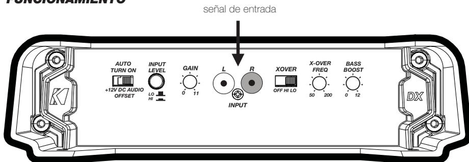
**Selección de Encendido Automático:** La serie DX ofrece tres modalidades de encendido automático que se pueden seleccionar en el panel de extremo: +12V, compensación de CC y audio. Las modalidades de audio o compensación de CC dan +12V a la terminal REM para encender otros amplificadores.
