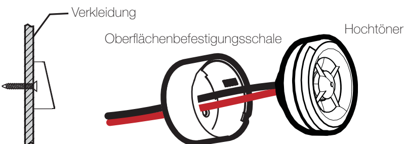
Abb. 6 Einbau auf der Oberfläche
