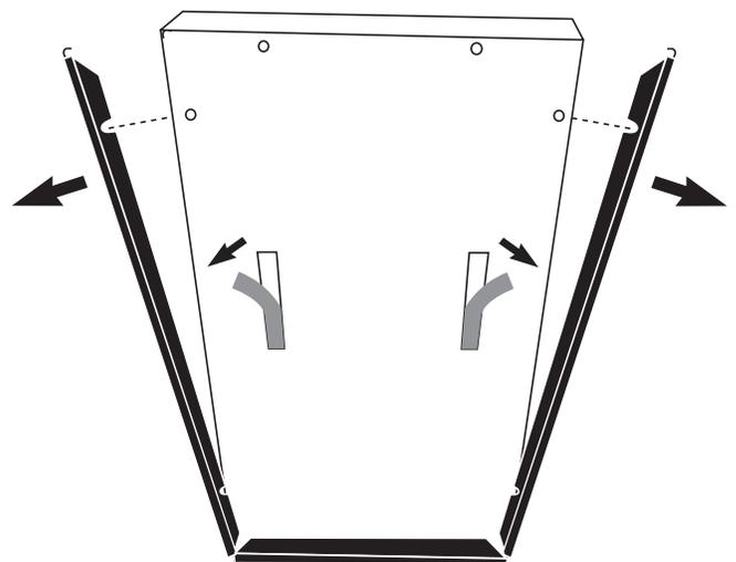
3. Deslice el panel decorativo por debajo de los extremos de las piezas de adorno inferiores y laterales. Vuelva a instalar el adorno lateral, asegurándose de que el sujetador del adorno lateral esté ubicado en la esquina interior del adorno inferior.
