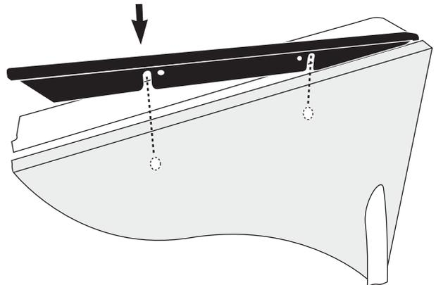
8. La garniture supérieure complètement engagée doit complètement recouvrir les attaches de la garniture latérale et être pratiquement en affleurement avec la partie supérieure de la porte.
