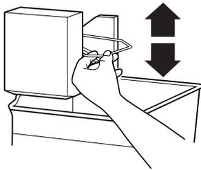
**REMARQUE :** Éteindre la machine à glaçons avant de retirer le bac d'entreposage pour servir des glaçons ou pour nettoyer le bac. Ceci empêchera les glaçons de tomber de la machine à glaçons et dans le compartiment de congélation. Après avoir remplacé le bac d'entreposage, mettre en marche la machine à glaçons.
