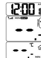
**AFFICHAGE DE LA TEMPÉRATURE MINIMUM** : Appuyer sur le bouton MAX/MIN pour afficher la plus basse température enregistrée.
