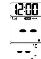
**AFFICHAGE DE LA TEMPÉRATURE MAXIMUM** : Appuyer sur le bouton MAX/MIN une autre fois pour afficher la plus haute température enregistrée.
