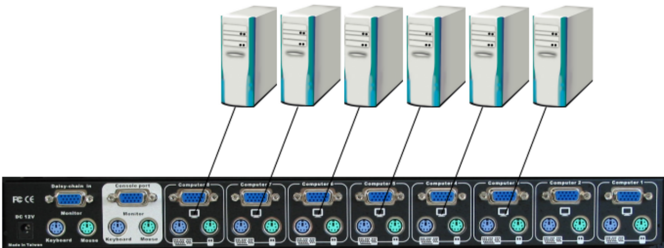
Connessione dei Computer (l'immagine mostra il CPU Switch P8)
