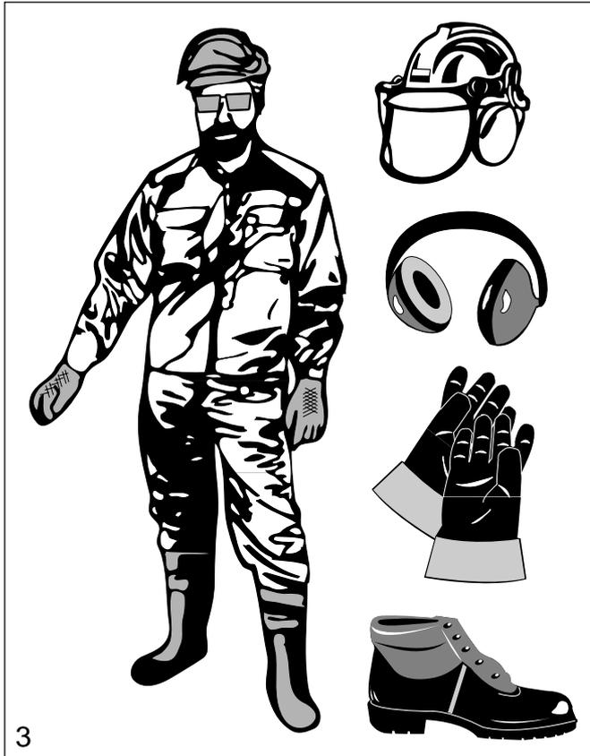
Pour travailler avec la tronçonneuse, il est important d'avoir une position stable au sol. Portez des chaussures montantes robustes munies de semelles antidérapantes. Il est conseillé de porter des chaussures de sécurité à embout d'acier.
