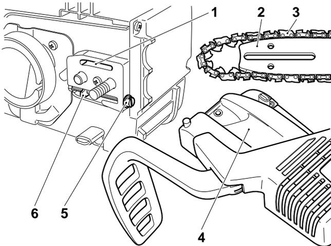
Enlever la protection de la roue de chaîne (4) (voir chapitre „MISE EN ROUTE“ A - B) et nettoyer l'intérieur, notamment la zone de la bande de freinage, au moyen d'un pinceau.
