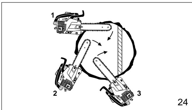
Pour la méthode de sectionnement (fig. 24), pratiquez la première coupe en faisant pivoter le guide vers le tenant. Ensuite, en utilisant la griffe du butoir comme un pivot, repositionnez la tronçonneuse pour la coupe suivante. Évitez de repositionner la tronçonneuse plus que c'est
