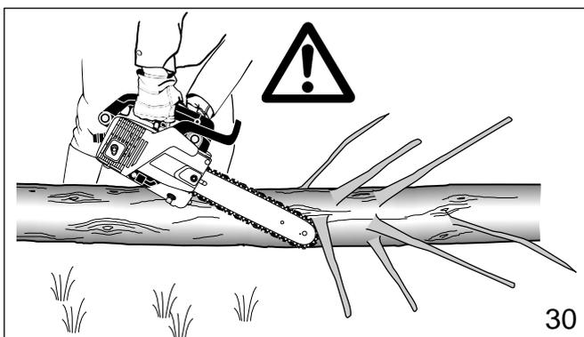
Commencez l'ébranchage en laissant les branches inférieures pour maintenir le tronc à une certaine distance du sol (fig. 30). Ne coupez pas les branches pendantes par dessous. La tronçonneuse pourrait être coincée ou la branche pourrait tomber, vous faisant perdre le contrôle de la tronçonneuse. Si le guide est coincé, arrêtez le moteur et retirez la tronçonneuse en soulevant la branche.
