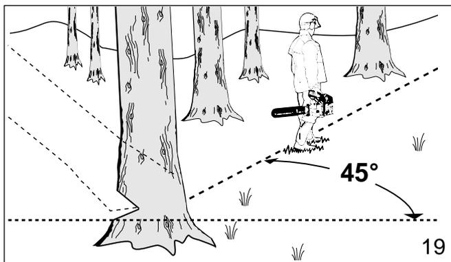
Etablissez ensuite une voie de repli et dégagez-la de tous les obstacles. Cette voie doit être opposée à la direction prévue de la chute de l'arbre et avoir un angle de 45° (fig. 19). Il faut aussi choisir une seconde voie. Placez tous les outils et l'ensemble du matériel en sécurité à une distance suffisante de l'arbre mais pas sur la voie de repli.
