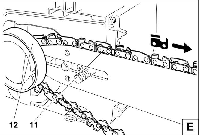
Guider la chaîne de sciage (11) autour de l'étoile de renvoi (13) du rail-guide de la chaîne.
