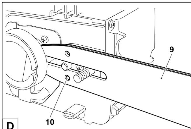
Monter le rail-guide de la chaîne (9). Veillez à ce que le tourillon (10) du tendeur de la chaîne pénètre dans le trou (voir cercle) du rail-guide de la chaîne.
