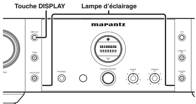
La lampe d'éclairage latéral dispose d'un mode toujours allumé et d'un mode toujours éteint.
