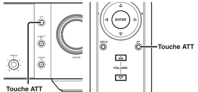
1. Appuyez sur la touche **ATT** du panneau avant ou de la télécommande pour réduire le niveau du volume de sortie.
