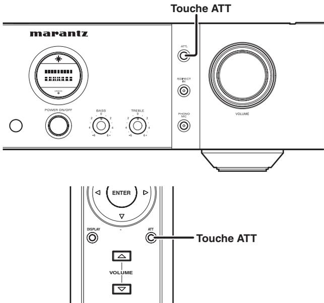
La touche ATT permet de réduire facilement le niveau du volume. Appuyez simplement sur la touche **ATT** sur l'appareil ou la télécommande pour réduire le niveau du volume.
