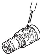
5. Serrez le bouton fermement en le tournant dans le sens horaire pour fixer le fil.
