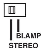
Le mode bi-amplificateur est activé en réglant le commutateur du mode de fonctionnement du panneau arrière sur « BI-AMP ». En mode bi-amplificateur, les signaux reçus sur le canal L sont envoyés par le sélecteur d'entrée vers les amplificateurs de volume gauche et droit.
