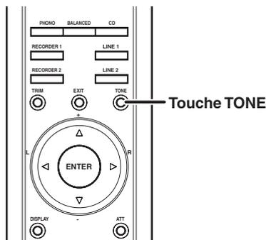
Avant d'ajuster la tonalité, appuyez sur la touche **TONE** du panneau avant ou de la télécommande pour la régler sur ON.
