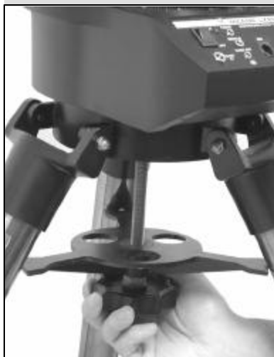
Fig. 4: Cómo fijar el telescopio al Trípode. Asegúrese de orientar la Charola Portaocular / Separador con el lado plano hacia arriba.
