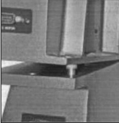
Fig. 52: Alínee las perforaciones sobre los pernos. Cuando estén en posición, deslice el tubo óptico para que los pernos se ajusten en las ranuras.
