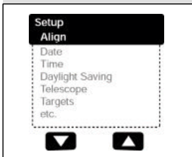
Fig. 17: La opción del menú se muestra en el segundo renglón. Use las flechas de avance para moverse hacia arriba o abajo en la lista de opciones. Presione ENTER para seleccionar la opción deseada.
