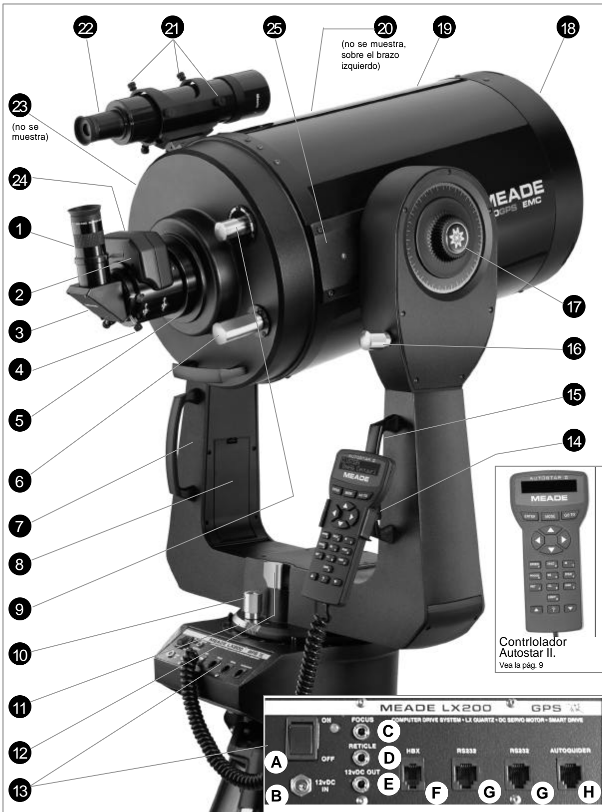
Fig. 1: El Telescopio LX200GPS, Panel de Control Computarizado (inserto); Controlador Autostar II (Inserto).
