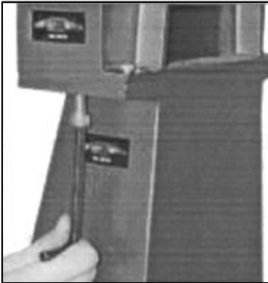
Fig. 53: Asegure los brazos utilizando la llave hexagonal.
