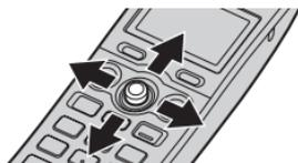
La palanca de control se puede utilizar para seleccionar el icono de la tecla flexible central, pulsando el centro de la palanca de control.
