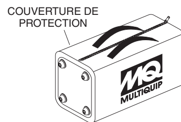
Figure 23. Entreposage de l'assemblage de la lampe
