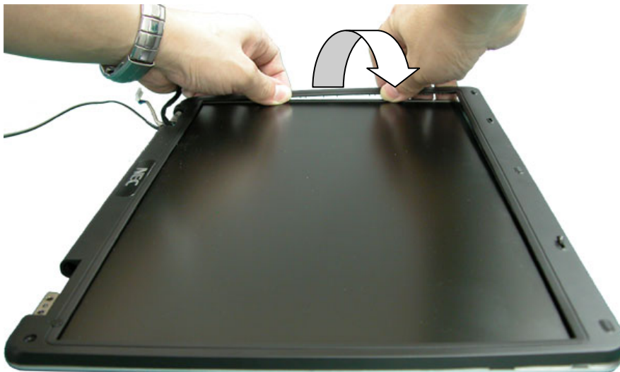
Fig. 26 Removing the LCD Bezel
