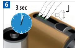
Aby przejść do trybu odwarpniania, naciśnąć jednocześnie wszystkie trzy przyciski wybioru rozmiaru filiżanki i przytrzymać je przez dłużej niż 3 sekundy. Krótki sygnał dźwiękowy potwierdzi wyjście z trybu odwarpniania. Diody obszaru dotykowego zaczną pulsować.
