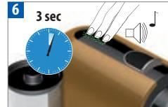
Um in den Entkalkungs-Modus zu wechseln, berühren Sie mind. 3 Sekunden lang gleichzeitig alle drei Kaffeeauswahl-Tasten. Ein Kontrollgeräusch bestätigt den Moduswechsel. Die Soft-Touch-Tasten blinken.
