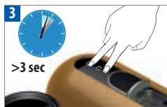
Para cambiar el modo de apagado automático de 9 a 30 minutos, cierre el deslizador y mantenga pulsados los botones Lungo y Ristretto durante más de 3 s. El botón Espresso se ilumina una vez. Para volver a la opción de 9 minutos repita el mismo procedimiento. El botón Espresso se ilumina tres veces.
