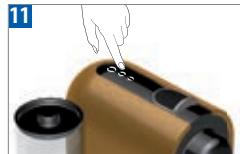
Um die Tassengröße während der Zubereitung zu ändern, berühren Sie einfach die gewünschte Soft-Touch-Taste. Das Gerät beendet sofort die Zubereitung, wenn die Füllmenge der neu gewählten Tastenauswahl bereits überschritten wurde.
