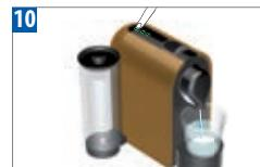
Następnie naciśnąć dowolny przycisk w celu przepłukania ekspresu. Po zakończeniu tej czynności urządzenie zatrzyma się.
