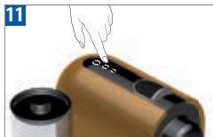
Chcete-li změnit velikost šálku během přípravy kávy, stiskněte příslušné tlačítko. Pokud objem vody přesáhl velikost nově zvoleného šálku, průtok se zastaví.
