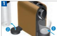
A noter, la machine reste bloquée pendant 10 minutes après la vidange! Retirez le réservoir d'eau. Placez un récipient sous l'orifice de sortie du café.
