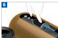
Zapněte přístroj (poloha ON) posunutím posuvníku směrem dozadu. Pokud tlačítka blikají, přístroj se nahřívá (cca 25 vteřin). Přístroj je připraven k použití, když tlačítka nepřetržitě svítí.
