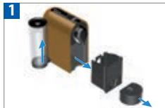
Retire el depósito de agua y el contenedor de cápsulas usadas. Ajuste la longitud del cable y almacene el exceso del mismo debajo de la máquina.
