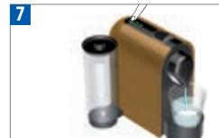
Si la fenêtre coulissante est fermée, appuyez sur un des bouton pour démarrer le détartrage. Si la fenêtre coulissante est ouverte, fermez-la pour démarrer le détartrage. La machine s'arrête une fois le réservoir d'eau vide. La machine clignotera de l'avant vers l'arrière pour signaler que le réservoir d'eau est vide.
