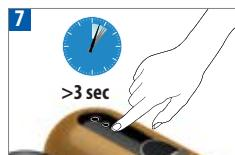
Přístroj lze kdykoliv vypnout (poloha OFF), je-li posuvník zavřený, podržením kteréhokoli z tlačítek po dobu minimálně 3 vteřin. Vypnutí potvrdí bliknutí zbylých dvou tlačítek.
