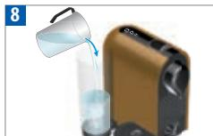
Füllen Sie den Wassertank wieder mit der aufgefangenen Entkalker-Lösung auf und wiederholen Sie den Vorgang, indem Sie eine der Soft-Touch-Tasten zweimal berühren.
