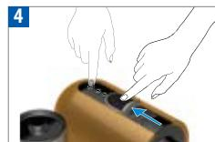
Spusťte přístroj stisknutím jednoho z tlačítek nebo posunutím posuvníku.
