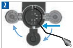
Selon votre souhait d'avoir le réservoir d'eau à gauche ou à droite, passez le câble dans la fente de gauche ou de droite. Installez la machine en position verticale.
