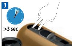
Pro změnu nastavení automatického vypínání z 9 na 30 minut zavřete posuvník a stiskněte tlačítko Lungo a Ristretto na min 3 vteřiny. Tlačítko Espresso jednou blikne. Pro návrat do původního nastavení na 9 minut postup opakujte, tlačítko Espresso blikne třikrát.
