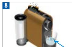
Placez un récipient sous l'orifice de sortie du café. Appuyez sur le bouton Lungo. Fermez la fenêtre coulissante pour rincer la machine. Répétez trois fois cette opération.
