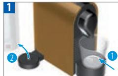
Hinweis: Das Gerät ist nach der Entleerung 10 Minuten lang blockiert. Entnehmen Sie den Wassertank. Stellen Sie ein Gefäß unter den Kaffeeauslauf.
