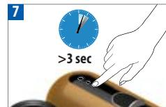
Ekspres można w każdej chwili wyłączyć, naciskając i przytrzymując dowolny przycisk przez dłużej niż 3 sekundy przy zamkniętej zasuwie. Wykonanie czynności potwierdzają pulsujące diody pozostałych dwóch przycisków.
