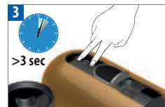
Pour instaurer le mode Arrêt automatique de 9 à 30 minutes, fermez la fenêtre coulissante et maintenez appuyées les touches Lungo et Ristretto plus de 3 secondes. Le bouton Espresso clignotera alors une fois. Pour restaurer le mode arrêt automatique à 9 minutes, répétez la même procédure. Le bouton Espresso clignotera trois fois pour confirmation.
