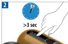
Přístroj je možné kdykoli vypnout, je-li posuvník zavřený, přidržením kterehokoli tlačítka po dobu 3 vteřin. Vypnutí potvrď bliknutí zbylých dvou tlačítek.
