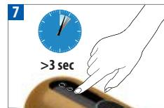
La machine peut être mise en mode Arrêt à tout moment quand la fenêtre coulissante est fermée en maintenant appuyé un des boutons tactiles pendant plus de 3 sec, confirmé par les 2 autres boutons clignotants.
