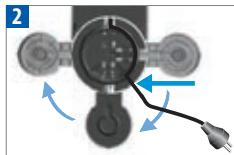
Volný konec kabelu vložte do vodící lišty umístěné pod nádobou na vodu vlevo nebo vpravo, podle polohy, kterou jste pro nádobu na vodu volili, a postavte přístroj do vertikální polohy.
