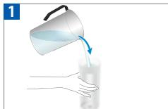
Füllen Sie Trinkwasser in den Wassertank.
