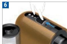
Encienda la máquina mediante la apertura del deslizador. Para ello, desplácelo hacia la parte trasera de la máquina. Luz intermitente en uno de los botones de café: precalentamiento de 25 segundos aproximadamente. Luz fija: la máquina está preparada.
