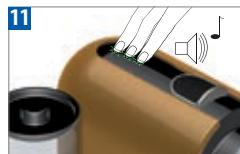
Aby wyjść z trybu odwarpniania, należy naciśnąć jednocześnie wszystkie trzy przyciski i przytrzymać przez dłużej niż 3 sekundy. Krótki sygnał dźwiękowy potwierdzi wyjście z trybu odwarpniania. Urządzenie jest gotowe do użytku.
