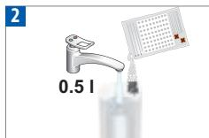
Füllen Sie den Wassertank mit einem Beutel der Nespresso Entkalkungslösung und 0,5 l Leitungswasser auf.
