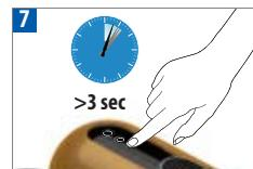
Sie können das Gerät jederzeit ausschalten, indem Sie eine beliebige Soft-Touch-Taste mind. 3 Sekunden lang berühren. Hierzu muss der Schieber geschlossen sein. Zur Bestätigung blinken die beiden anderen Tasten.
