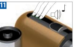
Um den Entkalkungs-Modus zu verlassen, berühren Sie mind. 3 Sekunden lang gleichzeitig alle drei Kaffeeauswahl-Tasten. Ein Kontrollgeräusch bestätigt den Moduswechsel. Das Gerät kann jetzt benutzt werden.
