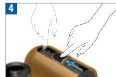
Encienda la máquina mediante el desplazamiento del deslizador o al pulsar uno de los botones de selección del tamaño de la taza.
