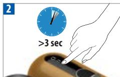
Ekspres można w każdej chwili wyłączyć, naciśkając i przytrzymując dowolny przycisk przez dłużej niż 3 sekundy przy zamkniętej zasuwie. Wykonanie czynności potwierdzają pulsujące diody pozostałych dwóch przycisków. Кофе-машину можно выключить в любое время, нажав и удерживая любую кнопку более, чем 3 секунды, при этом световые сигналы двух других кнопок будут мигать.
