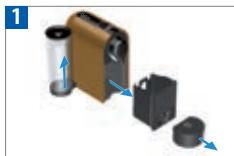
Entnehmen Sie den Wassertank und den Kapselbehälter. Stellen Sie die Kabellänge ein und verstauen Sie den Rest des Kabels unter dem Gerät.
