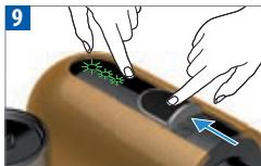
Aby przerwać nalewanie kawy wcześniej, należy naciąść aktywny przycisk lub przesunąć zasuwę do oporu w kierunku tylnej części ekspresu.
