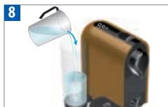
Ξαναγεμίστε το δοχείο νερού με το χρησιμοποιημένο διάλυμα καθαρισμού που έχετε συγκεντρώσει στο δοχείο και πατήστε οποιδήποτε κουμπί για να επαναλάβετε τη διαδικασία.
