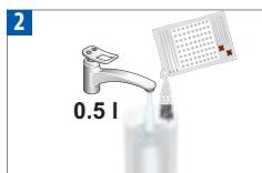
Do zbiornika na wodę wlać 1 jednostkę płynu odkamieniającego Nespresso i dodać 0,5 l wody. Наполните резервуар для воды 1 порцией жидкости для удаления накипы Nespresso и добавьте 0,5 л/17 унций воды.
