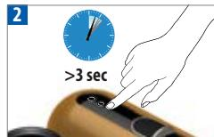
Sie können das Gerät jederzeit ausschalten, indem Sie eine beliebige Soft-Touch-Taste mind. 3 Sekunden lang berühren. Hierzu muss der Schieber geschlossen sein. Zur Bestätigung blinken die beiden anderen Tasten.
