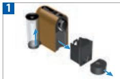
Retirez le réservoir d'eau et le réservoir à capsules. Ajustez la longueur du câble en utilisant l'espace range-câble sous la machine.
