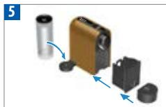
Umieścić ociekacz i pojemnik na zużyte kapsułki we właściwym miejscu. Dla twojego bezpieczeństwa, korzystaj z urządzenia tylko z właściwie umiejscowionym ociekaczem i pojemnikiem na kapsułki. Umieścić zbiornik na wodę na ramieniu. Zbiornik mocowany jest na magnesach.
