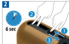
Pozor: Přístroj je blokován po dobu 10 minut po vypuštění! Odstraňte nádobu na vodu. Postavte pod výpusťkávý vhodnou nádobu.
