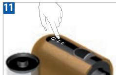
Para modificar durante la preparación el tamaño de taza seleccionado, pulse el botón correspondiente al nuevo tamaño de taza deseado. La máquina se detendrá automáticamente si el volumen de café extraído ya es superior al correspondiente al nuevo tamaño de taza deseado.
