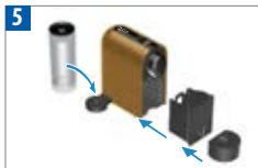
Βάλτε το δοχείο νερού στο βραχίονα του, η θέση του σταθεροποιείται με μαγνήτες. Τοποθετήστε το δίσκο αποστράγγισης και το δοχείο συλλογής καψουλών στη θέση τους. Για την ασφάλεια σας, χρησιμοποιήστε τη μηχανή μόνο όταν ο δίσκος αποστράγγισης και το δοχείο συλλογής καψουλών βρίσκονται στη θέση τους.
