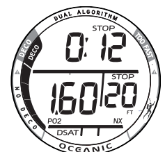
Fig. 41 - PO2 ALARM DECO
