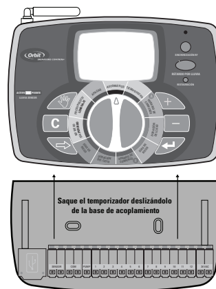
Figura 3: Cómo montar la base de acoplamiento
