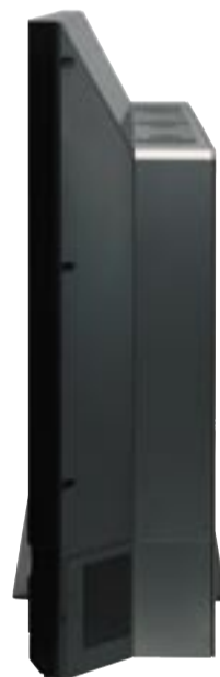
Selbst bei riesigen Bildschirmdiagonalen von 165 und 147 cm beträgt die Gehäusetiefe nur noch 27 cm.
