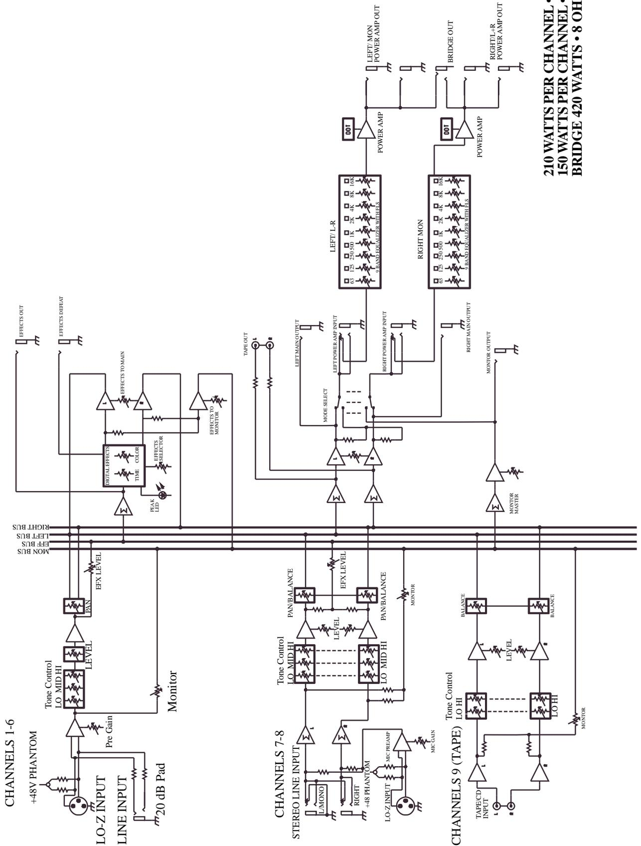
**210 WATTS PER CHANNEL • 4 OHMS**
