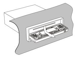
THE FRONT PANEL WILL SLIDE DOWN AUTOMATICALLY.
