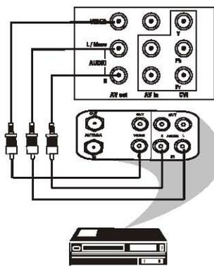
– Conecte los cables RCA de video y audio desde los enchufes INPUT del VCR a la salida MONITOR OUT que se encuentra en la parte posterior del TV.
