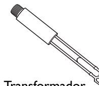
Transformador de adaptación
