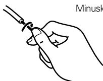
2. Den Hebel nach unten drücken, das Kabel in die Öffnung einführen, dann den Hebel wieder loslassen.
