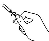
2. Empuje la palanca, inserte el cable en el orificio, y libere la palanca.
