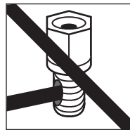
Ne pas insérer la partie isolée du fil du haut-parleur.
