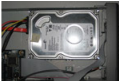
Image 2.1 Branchement du disque dur
