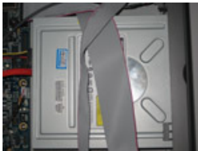
Image 2.3 Connexion du graveur
