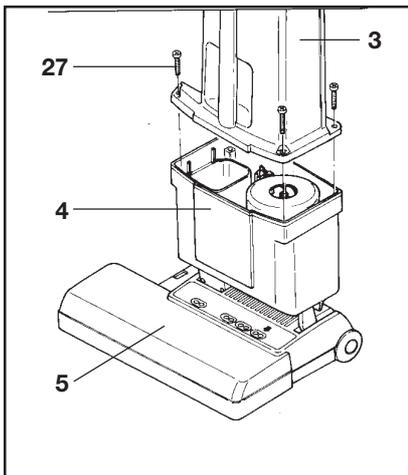
Zum Abnehmen des Filtergehäuses (3) vom Motorgehäuse (4) den Saugteil eingerastet auf der Teppichbürste (5) stehen lassen. Filterdeckel und Schlauch abnehmen, die 4 Schrauben (27) lösen und das Filtergehäuse vorsichtig vom Motorgehäuse abziehen.
