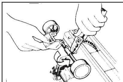
Beim Einsetzen der Achse die Öse der Drehfeder im Stift der Achse einhängen, den geraden Schenkel der Feder mit Zange greifen und Feder in Pfeilrichtung spannen. Die Feder so lange festhalten, bis die Achse richtig im Unterteil eingesetzt ist.
