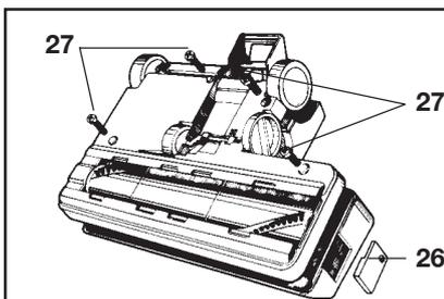
Zum Öffnen der Teppichbürste die Verschlusskappe (26) abschrauben. An der Unterseite nur die 4 großen Schrauben (27) lösen und dann das Oberteil abziehen.
