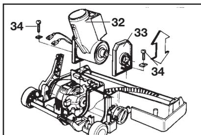
Zum Herausnehmen des Gelenkes (32) die beiden Schrauben (34) an den Gelenklagern (33) lösen und Gelenk mit Gelenklagern aus den Gehäuseschlitzen ziehen.
