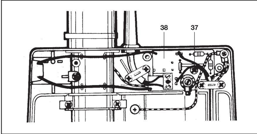
Zum Abnehmen der Abdeckung die drei Schrauben lösen und mit dem Schraubendreher abheben. Durch Lösen der Schraube (37) kann die Leiterplatte (38) entnommen werden.
